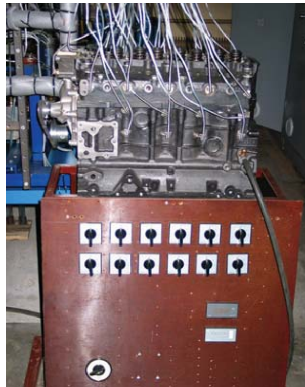
Rys. 3. Zespół grzania korpusu silnika 4CT90: a – grzałki wewnątrz cylindrów z wyprowadzonymi elektrycznymi przewodami zasilającymi, b – zestaw włączników grzałek elektrycznych oraz wskaźników temperatury wewnątrz grzałek
